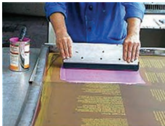
شکل ۶- راکل کشیدن روی توری
