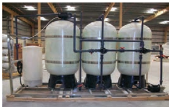
شکل ۶۲- نمونه یک دستگاه سختی‌گیر آب است.
