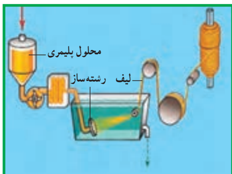
شکل ۱۱-۶- مراحل تولید نخ یک‌سره با روش ترریسی
