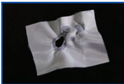
شکل ۱۰-۴ اثر استن بر پارچه استات
