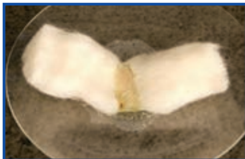
شکل ۳-۸- اثر سود با غلظت ۵ درصد بر الیاف پشم
