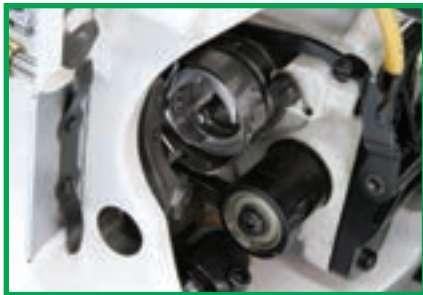
شکل ۶-۸ - ماسوره، ماکو و قاب ماکو
