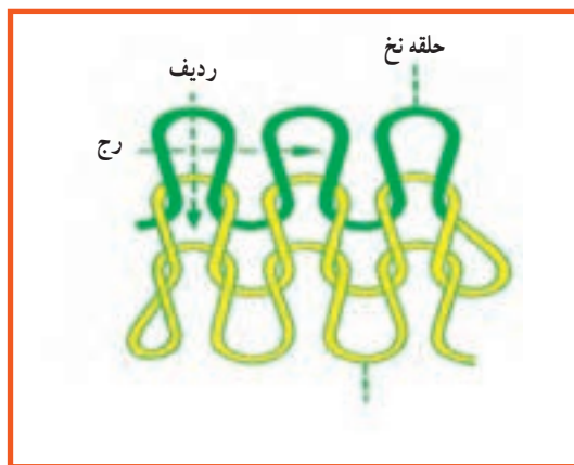
شکل ۸-۹- ساختار پارچه حلقوی پودی
