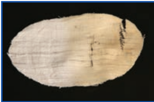
شکل ۲-۶- تجزیه پارچه پنبه‌ای در دمای ۱۵۰ درجه سانتی‌گراد
