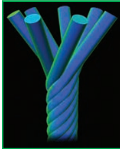
شکل ۶-۶- نحوه تابیدن الیاف به دور یکدیگر
