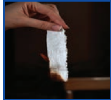
شکل ۴-۳ سوختن پارچه ویسکوز ریون
