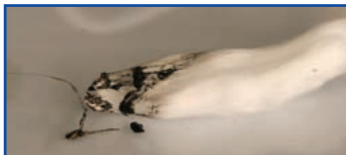
شکل ۵-۱۴- خاکستر حاصل از سوختن الیاف اکریلیک
