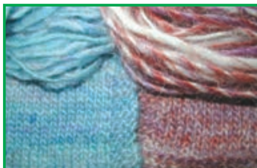
شکل ۳-۷- نخ با تاب کم و پارچه بافته شده از آن
