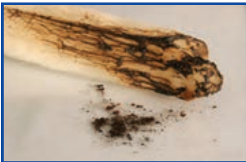
شکل ۳-۷ خاکستر حاصل از سوختن الیاف پشم
