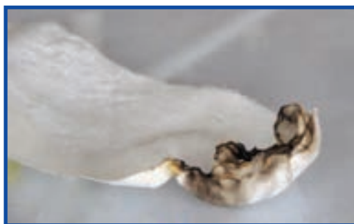
شکل ۵-۹ - خاکستر حاصل از سوختن پارچه از جنس پلی استر
