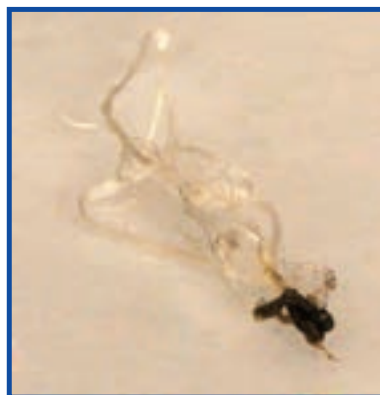
شکل ۵-۳- خاکستر حاصل از سوختن نخ نایلونی
