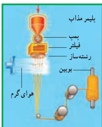
شکل ۱۰-۶- مراحل تولید نخ یک‌سره
