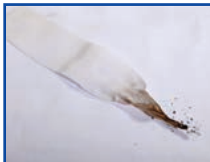
شکل ۹-۴ خاکستر حاصل از سوختن پارچه استات
