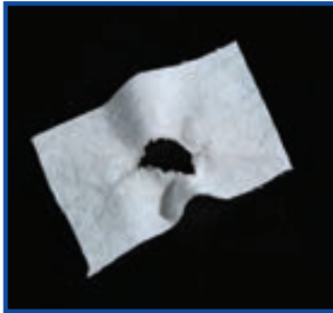
شکل ۴-۵ اثر اسید کلریدریک بر پارچه ویسکوز ریون
